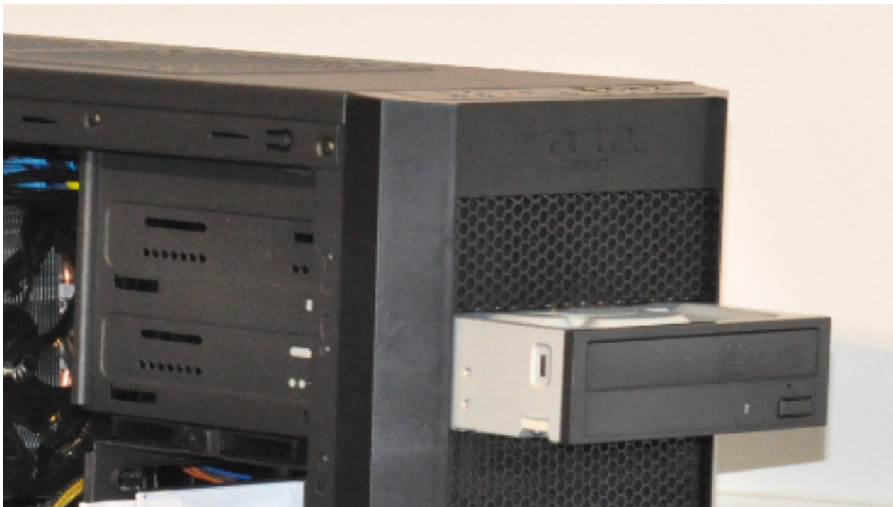
FIGURE 11.11. – Insertion du lecteur/graveur dans le boîtier
