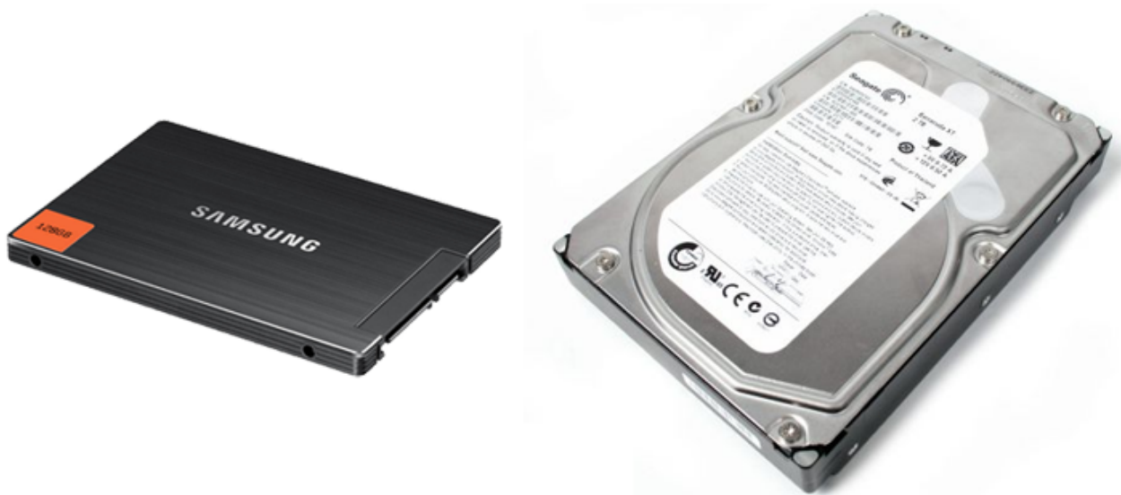
FIGURE 11.8. – À gauche notre SSD pour l'OS et les programmes, à droite notre disque dur pour les données
