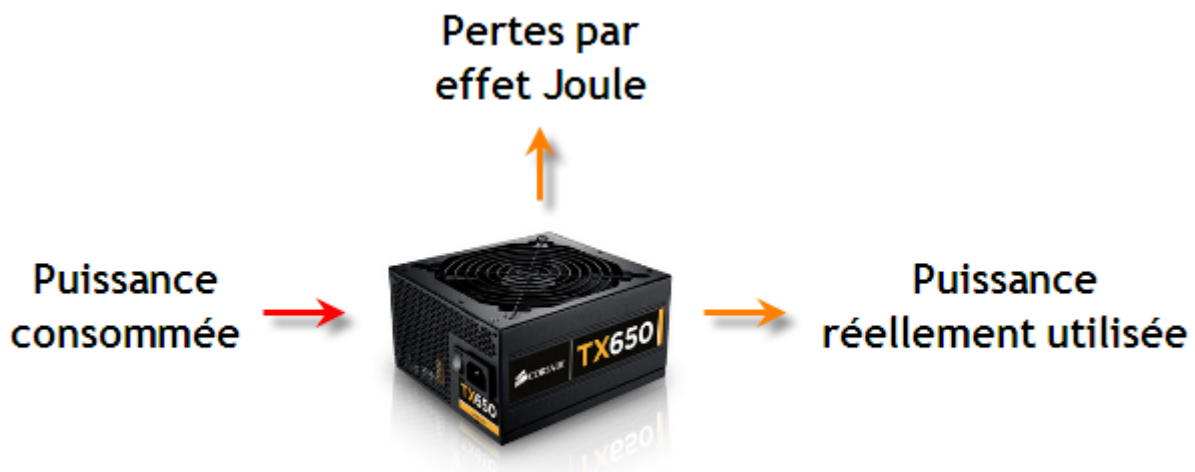
FIGURE 5.13. – Une partie de la puissance consommée est perdue en chaleur, c'est l'effet Joule
