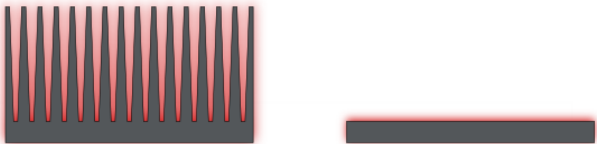
FIGURE 1.2. – À gauche sur le schéma ci-dessus, la surface de contact entre le CPU et l'air est bien plus grande grâce aux ailettes qu'avec la surface plane à droite
