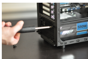
FIGURE 11.7. – Fixation du bloc d'alimentation
