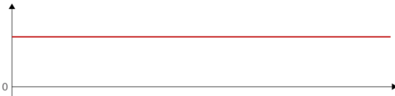
FIGURE 5.3. – Évolution de la tension d'un courant continu au cours du temps
