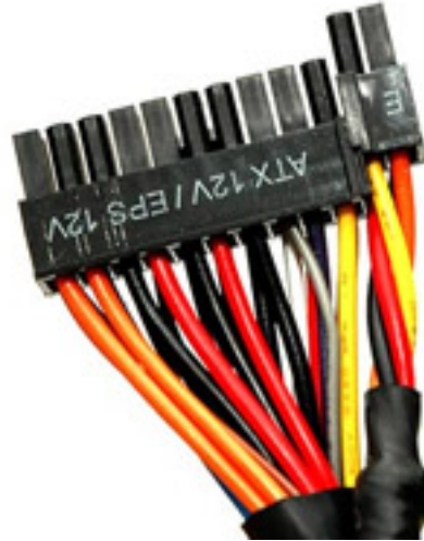
FIGURE 5.15. – Connecteur d'alimentation ATX 24 broches
