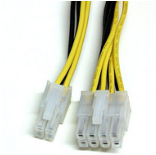
FIGURE 5.16. – Connecteur d'alimentation ATX 8 broches ou ATX-P4
