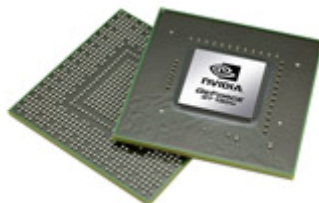
FIGURE 3.1. – Le GPU, le processeur de la carte graphique
