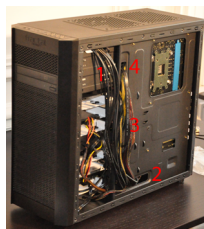
FIGURE 12.8. – Passage des câbles derrière la plaque de la carte mère
