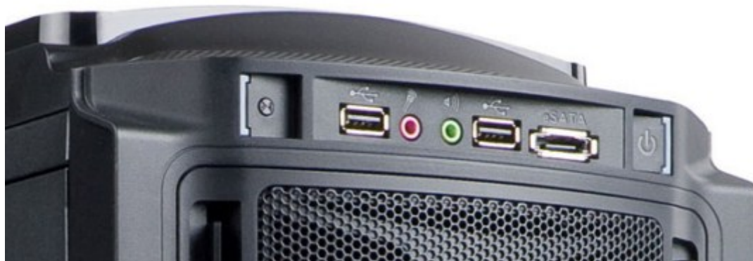
FIGURE 6.8. – Ports disponibles en façade : deux audio, deux USB et un eSATA
