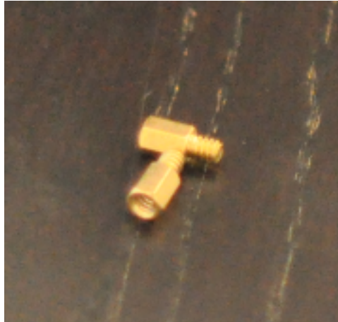
FIGURE 10.17. – Les entretoises, servant à fixer la carte mère sur le boîtier
