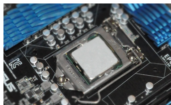
FIGURE 10.6. – La pâte thermique doit recouvrir de façon uniforme le CPU
