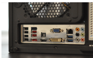
FIGURE 10.16. – Mise en place de la plaque du BackPanel
