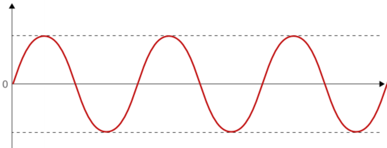
FIGURE 5.2. – Évolution de l'intensité d'un courant alternatif au cours du temps
