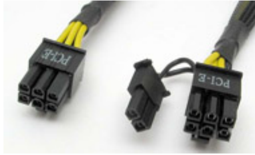
FIGURE 5.17. – Connecteur d'alimentation PCIe
