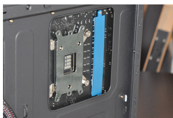
FIGURE 10.20. – Un trou dans le boîtier permet d'accéder facilement à la fixation du ventirad
