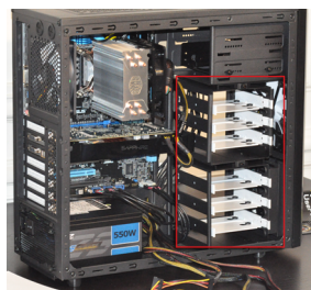
FIGURE 11.9. – Les disques durs et SSD se placent dans les tiroirs prévus à cet effet, à l'avant de la tour
