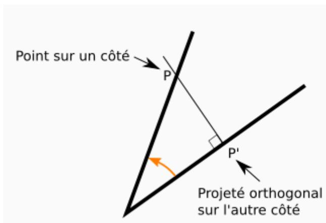
FIGURE 2.2. – Le point qu'on projette est P, le projeté est P'. La droite (PP') est perpendiculaire au côté sur lequel P' se trouve, P' est ainsi le projeté orthogonal de P.
