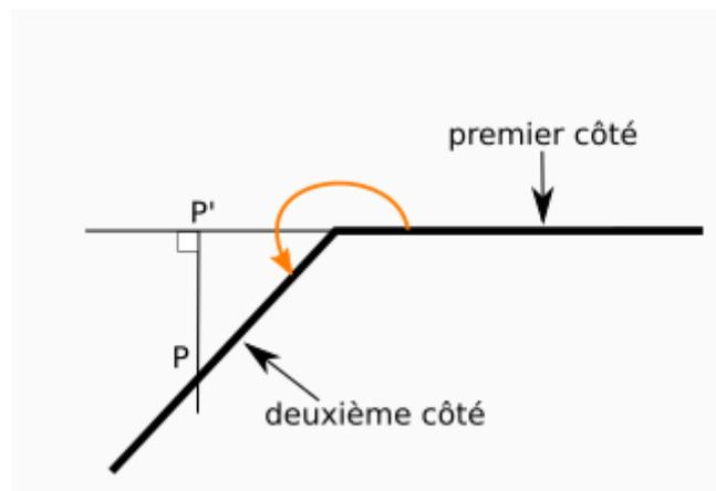
FIGURE 3.4. – Cas d'un angle positif entre  $180^\circ$  et  $270^\circ$  : deuxième côté en dessous et projeté à gauche sur le prolongement du côté.
