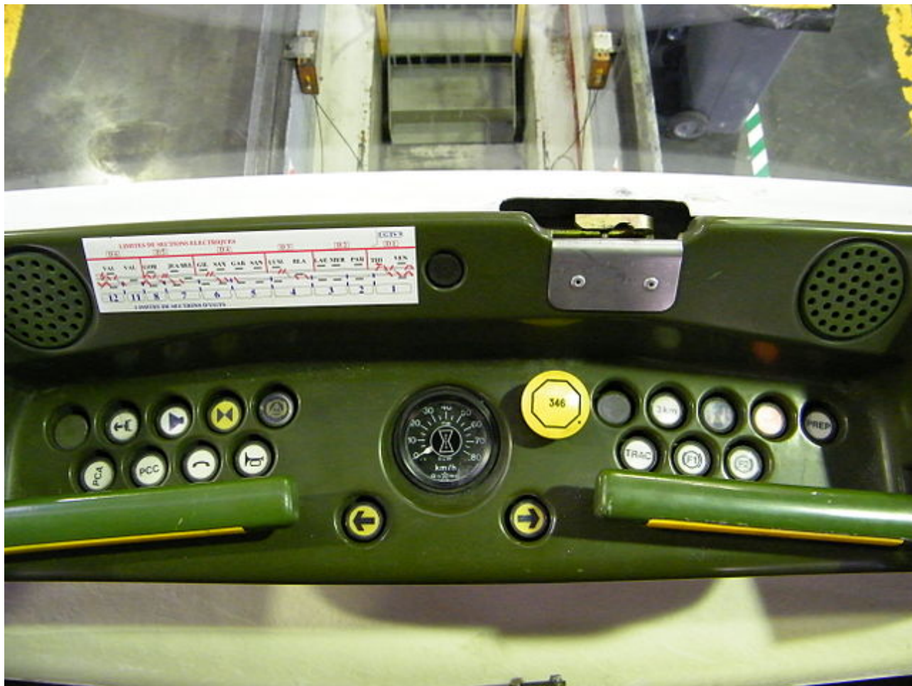
FIGURE 3.10. – Pupitre de conduite en manuel (CC BY-SA 3.0 Ibou69100)
