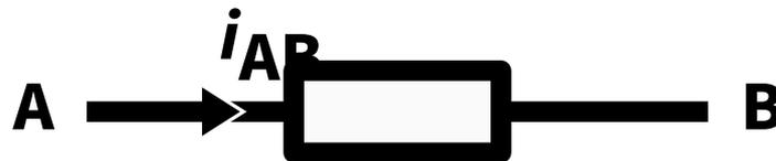
FIGURE 1.1. – Flèche montrant le courant circulant de A vers B dans un dipôle quelconque.
