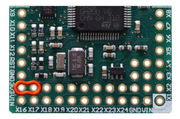
Maintenant, connectez la pyboard en USB. La carte démarre et se met en mode mise à jour. Vous pouvez le constater par l'allumage des LED différent d'un démarrage normal (LED bleue et rouge allumées pour ma part).
