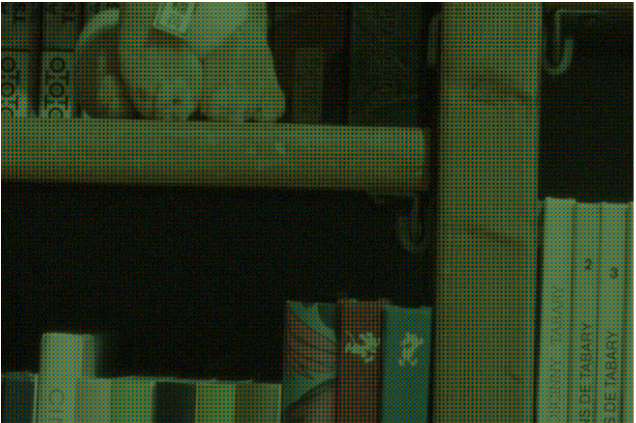
FIGURE 1.3. – Correspondance 1 photosite \rightarrow 1 pixel coloré selon le masque, découpe au centre de l'image
